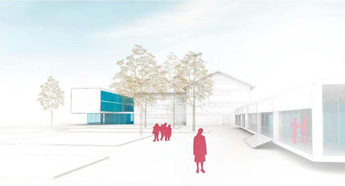
Auch an das bestehende Werkstattgebäude wurde in Richtung See ein Zubau angefügt. Im Erdgeschoß ist neben einer Erweiterung des Maschinenraums für die CNC – Bearbeitung auch die Werkstätte des schulautonomen Ausbildungszweiges „Bootsbau“ untergebracht. Das erste Obergeschoß nehmen zwei Klassenräume für den fachtheoretischen Unterricht ein, während im dritten Obergeschoß die Werkstätten des Instrumentenbaus eingerichtet sind.
